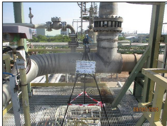
รูปที่ 4.9 การตรวจวัดปริมาณแอมโมเนีย บริเวณ Ammonia Vent Scrubber
