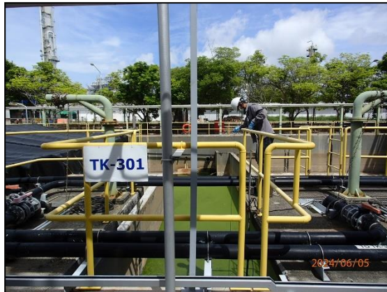
รูปที่ 4.5 การเก็บตัวอย่างคุณภาพน้ำ บริเวณจุดระบายน้ำฝนจาก Storm Water Diversion Box (TK 301)
