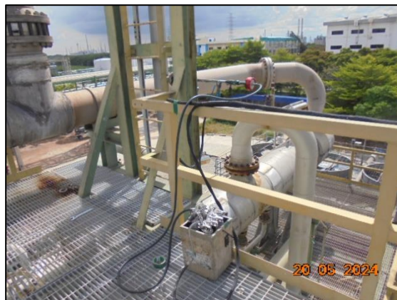
รูปที่ 4.1 การเก็บตัวอย่างคุณภาพอากาศจากแหล่งกำเนิด บริเวณ ปล่อง Ammonia Vent Scrubber
