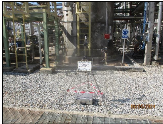
รูปที่ 4.11 การตรวจวัดระดับเสียงในสถานประกอบการ บริเวณกระบวนการผลิต
